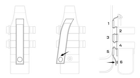
放入水瓶后,请将水壶袋上的弹力绳套于瓶口下方瓶身。在操作摩托车前,请再次检查水壶袋是否已连接牢固。
